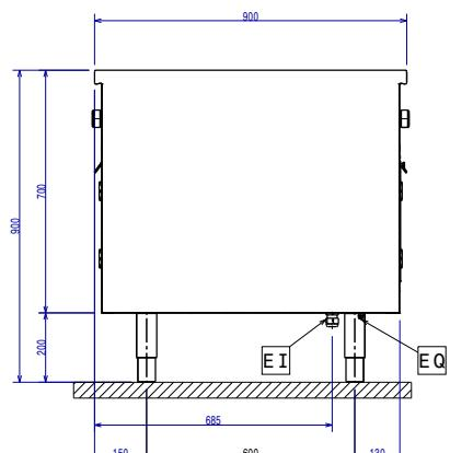
**EI** = Conexión eléctrica (energía)
